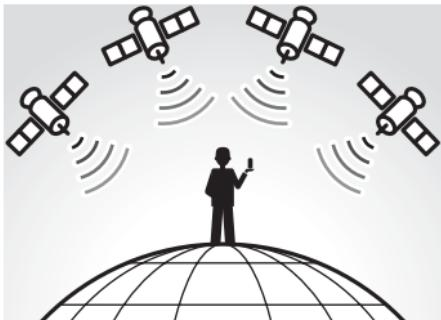
Een locatie berekenen wordt "een positiebepaling" genoemd. Een GPS-ontvanger kan de lengtegraad en breedtegraad van een locatie berekenen aan de hand van de ontvangen signalen van drie satellieten.
