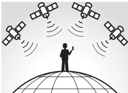
Das Messen einer Position nennt man „Tracking“ (Verfolgung). Ein GPS-Receiver kann die geographische Breite und Länge einer Position durch den Empfang von Signalen von drei Satelliten ausfindig machen.
